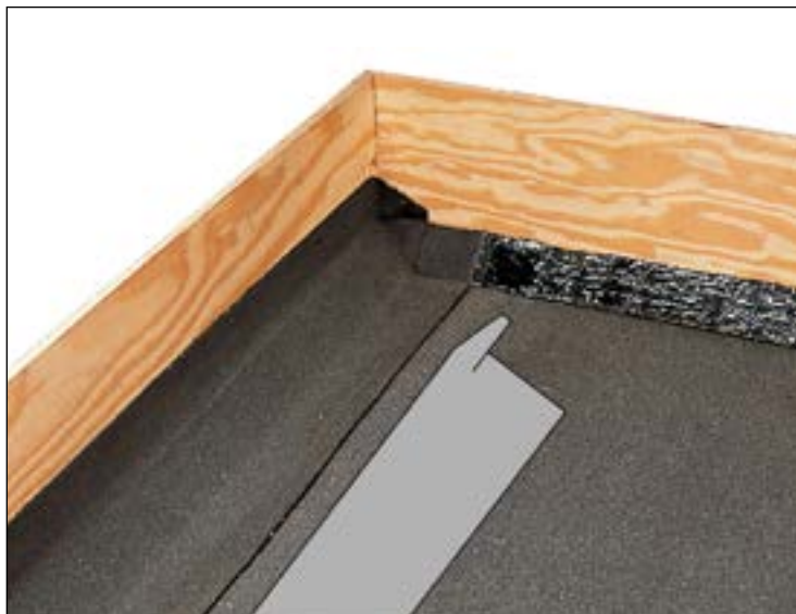
Figur 3.2.a: Indadgående hjørne. Første understrimmel vist som principkitse.
