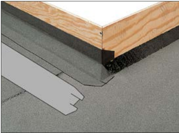
Figur 3.3.a: Udadgående hjørne. Første understrimmel vist som principskitse.
