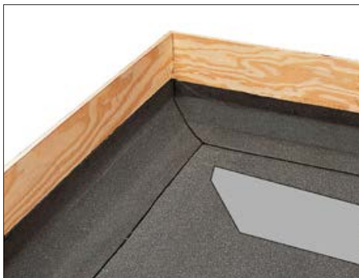
Figur 3.2.b: Indadgående hjørne. Anden understrimmel vist som principkitse.
