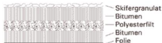
Figur 1 Opbygning af PTM BituFlex
